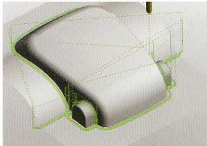
モデルの隅部を自動的に検出して、工具パスを作成します。両側にパスを追加するペンシルオフセット加工や角度指定による上から下への加工も可能です。
