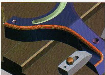
複数の曲面に沿って加工パスを作成します。リンク移動が少なく、曲面に沿っての加工なので、仕上り面の精度向上につながります。
