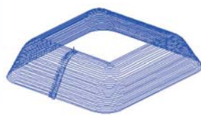
等高線 XY面から基本形状、XZ面から斜面形状を指定します。 仕上げ・荒取りが選択、荒取りは下穴、ヘリカル等アプローチ指定有り。
