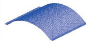
スロープZ YZ面/ZX面の基本形状を斜面に沿って 加工定義することができます。
