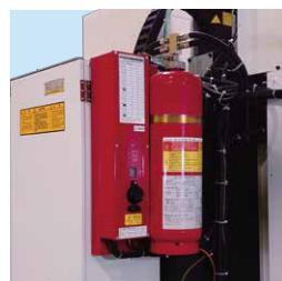
自動消火装置 (注)
