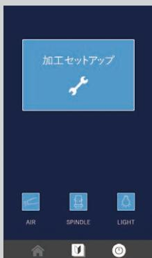
ライトユーザー向けに機能をそぎ落とし、導入したその日から立ち上げ可能な新機能「アシストモード」を搭載しました。加工プログラム選択から送り速度の調整、ワーク設置までTAKMillが誘導してくれます。
